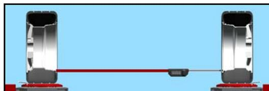
Fig. 23: Misurazione della carreggiata
